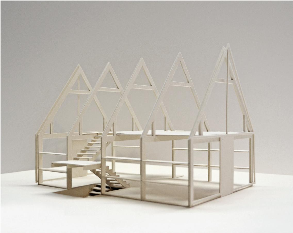
Primärkonstruktion aus Massivholzquerschnitten
